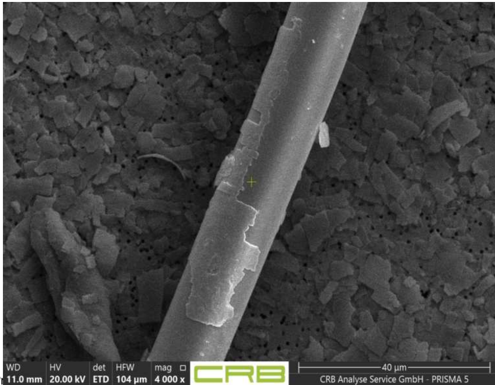
Babio Biotechnology (CRB-Nr.: 211552-REM): Faser ohne Beschichtung vor (oben) und nach (unten) der Analytik unter dem Elektronenstrahl
