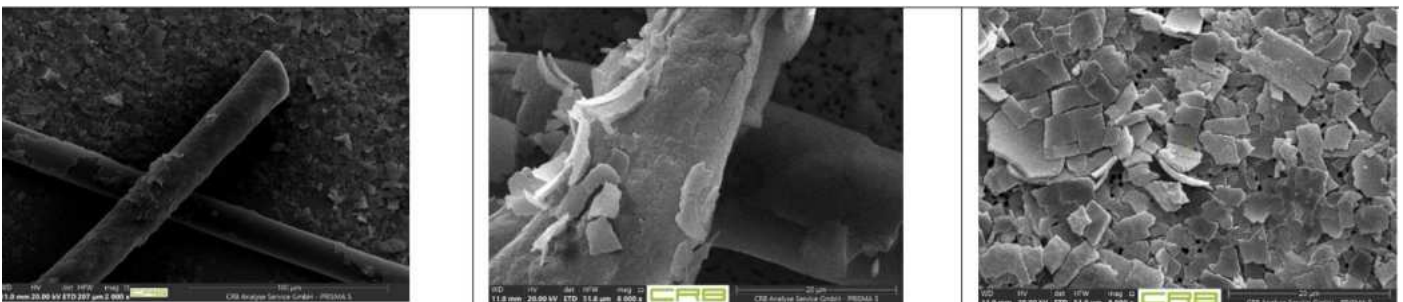
Abbildung 5: REM-Aufnahmen PCR-Pooltest-Probe-Abstrichtupfer – MIT Speicheleinwirkung – Filtrat auf Kernporenfilter (~0,8 µm)
